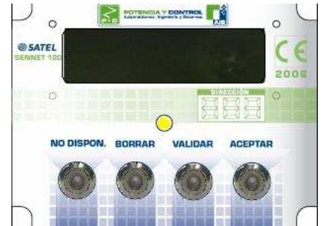
Imagen 5: Terminal de carretilero Desde la pantalla de PC podemos conocer el estado de las antenas, Terminales, pulsadores, colas de llamadas etc.
